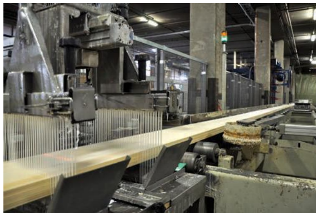
Anlægget kan med en temperatur på 55 grader og højfrekvente bølger lime seks meter limtræ på mellem halvandet og fem minutter – afhængigt af tykkelsen. De længste bjælker (på billedet her) er 24 meter lange og op til en meter tykke. Produktionslinjen er knap 70 meter lang.
