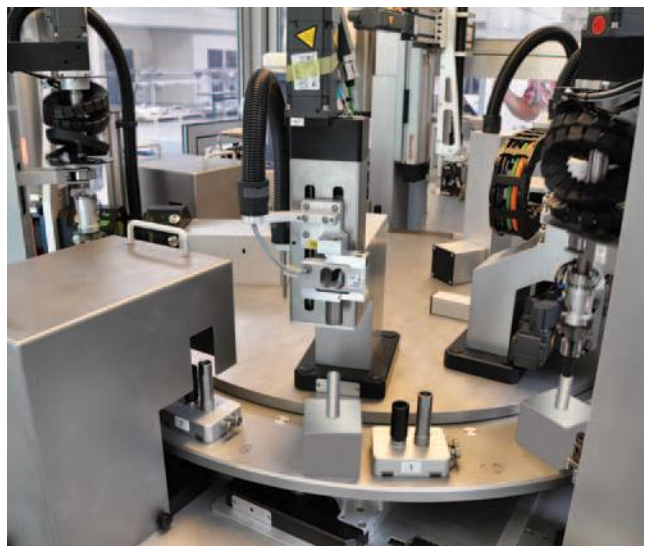
Produktionsanlægget er bygget op over et roterenderundbord. Emnerne er placeret i en lille holder, der kører rundt mellem de forskellige montage- og testrobotter.
