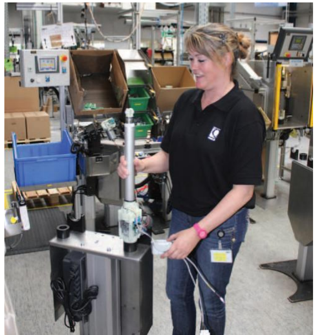
Montering af aktuatorerne sker i små enmandsbetjente produktionsceller, hvor det er den samme medarbejder, der samler, færdiggør og tester aktuatoren. Her demonstrerer produktionstekniker Vivi Bendorff Wolff en af arbejdsgangene.
