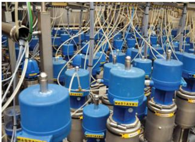
Matrix med ventiler i blanderiet på Carlsberg Læsk. Renoveret af Sinus Automation i foråret 2012.
